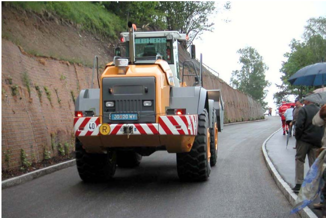
Bild 3 Schanzenstraße: Neben Tradition stand bei der Eröffnung auch eine Belastungsprobe auf dem Programm: Die neue Schanzenstraße wurde mit einem Pferdefuhrwerk, einem Oldtimer sowie der Drehleiter der Feuerwehr und dem 24 Tonnen schweren Radlader L 574 der Firma Liebherr erstmals offiziell befahren.
